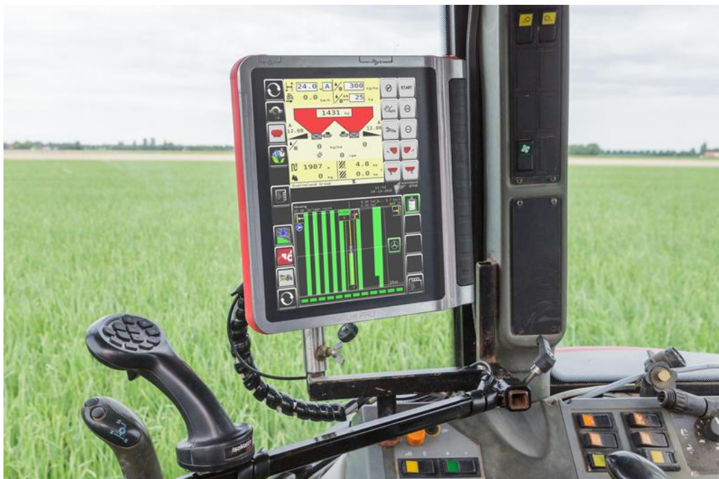
Slika 1.3. Virtuelni terminal osetljiv na dodir koji ima mogućnost prikaza podataka sa više različitih mašina
